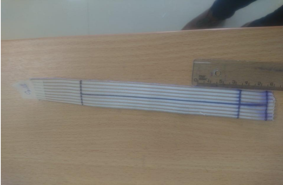
Anexo 12. Medición del recorrido de humedad en 30min
