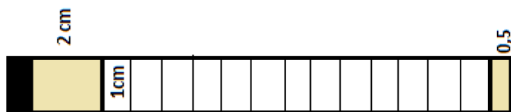
Figura 33. Señalización de la muestra para la prueba de absorción de la humedad
