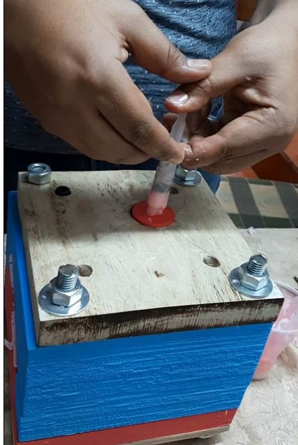
Figura 22. Inyección del material
