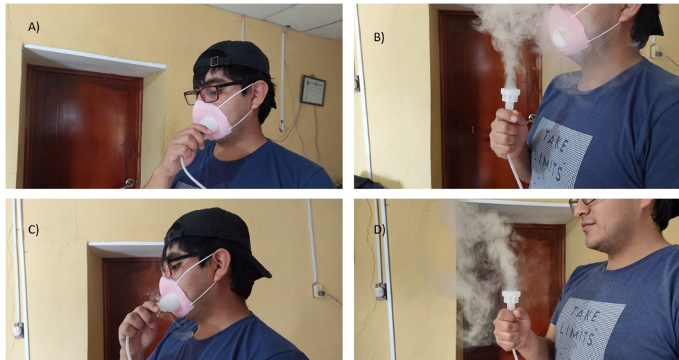
Figura 27. Prueba de fugas
