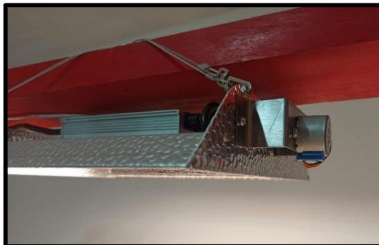
Figura 3.4. Motor a pasos colocado en la perilla de la luminaria Wills [Autor].
