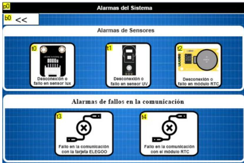
Figura 2.25. Diseño de la pantalla secundaria: Alarmas del sistema [Autor].
