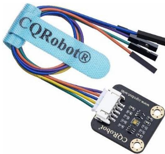
Figura 2.14. Sensor seleccionado CQRobot de luminosidad ambiente [44].
