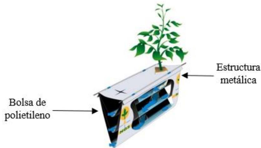
Figura 1.3. Sistema NGS, compuesto por capas de bolsas de polietileno [23].
