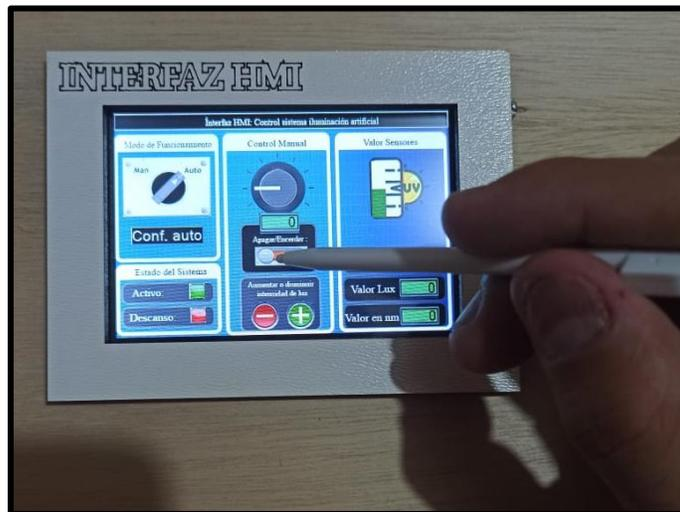
Figura 3.6. Panel de control local en el módulo hidropónico [Autor].
