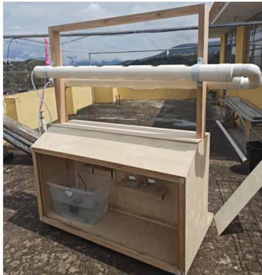
Figura 3.1. Módulo de cultivo hidropónico NFT [Autor].
