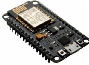
Ilustración 6. Placa NodeMCU ESP E12
