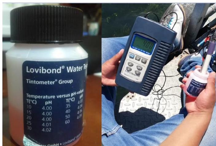
Ilustración 30. Calibración del sensor pH (UTN)
