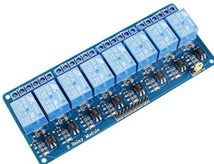
Dentro de la gran variedad de proyectos que podemos realizar con Arduino, podemos llegar a desear controlar componentes de alto voltaje o alto amperaje, como bombillas o bombas de agua, los cuales no pueden ser manejados directamente con Arduino. En estos casos es necesario utilizar Relays o Reles, estos dispositivos permiten controlar cargas de alto voltaje con una señal pequeña.
