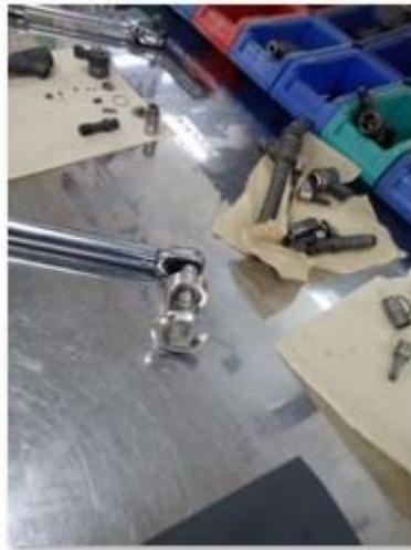
Figura 74 Racha especial para desarmar inyectores
