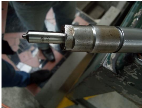
Figura 26 Toberas del inyector Bosch
