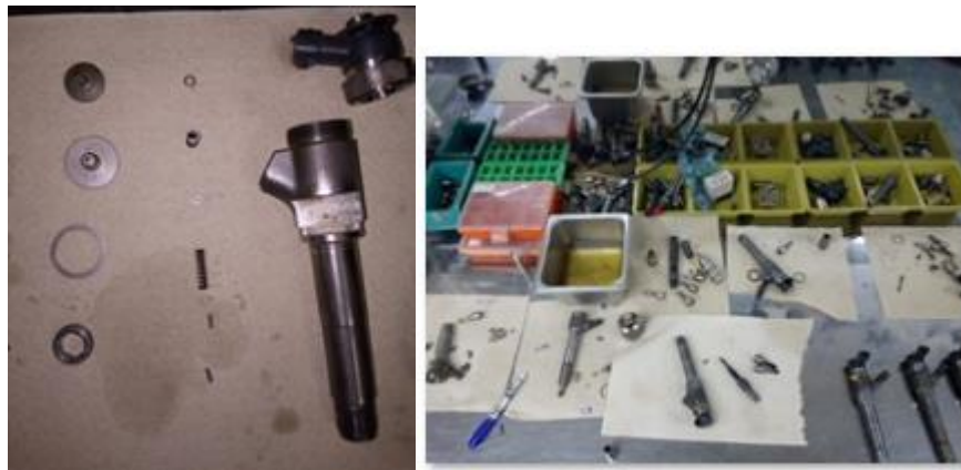
Figura 76 a) Despiece del inyector. b) Partes del inyector
