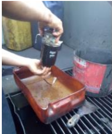
Figura 47 Limpieza de la bomba auxiliar
