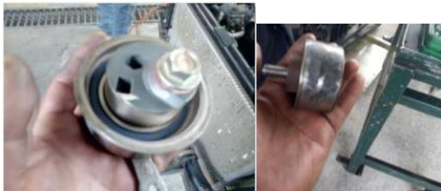
Figura 62 a) templador en buen estado. b) Templador en mal estado
