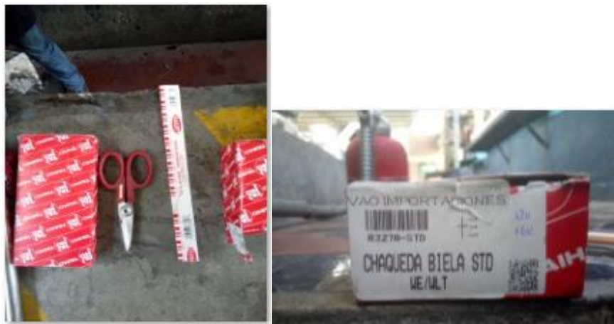
Figura 58 a) Plastigage. b) Cojinetes de biela
