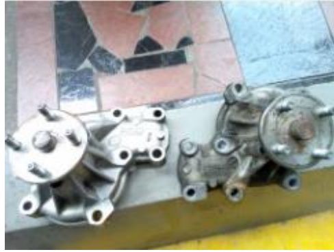
Figura 68 Bomba nueva, bomba antigua
