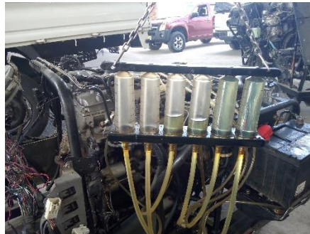
Figura 50 Medición del combustible en las probetas
