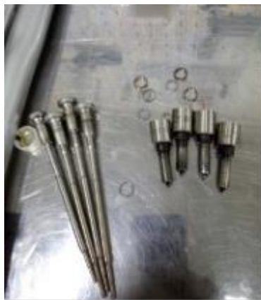
Figura 77 Toberas y agujas del inyector
