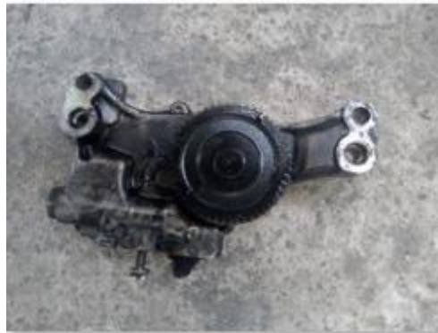
Figura 54 Coladera de aceite
