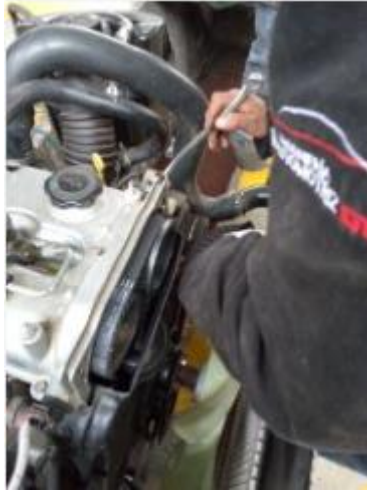
Figura 65 Colocación del protector frontal
