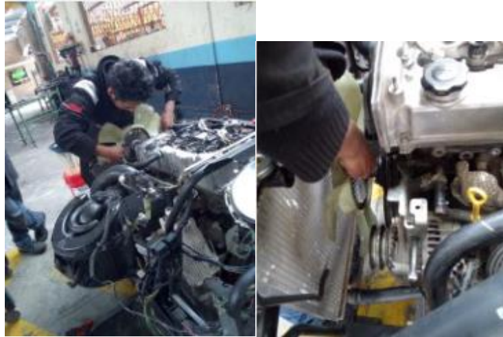
Figura 66 a) Extracción de las bandas. b) Retiro del ventilador
