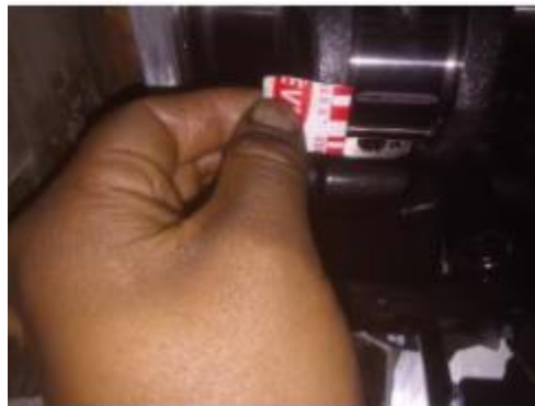
Figura 60 Medición de paso de luz con ayuda del plastigage
