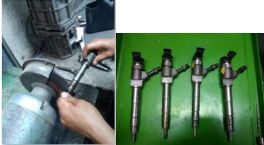
Figura 72 a) Limpieza del inyector. b) Inyectores
