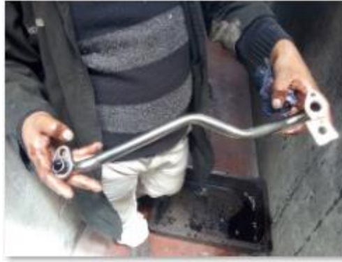
Figura 53 Coladera de aceite
