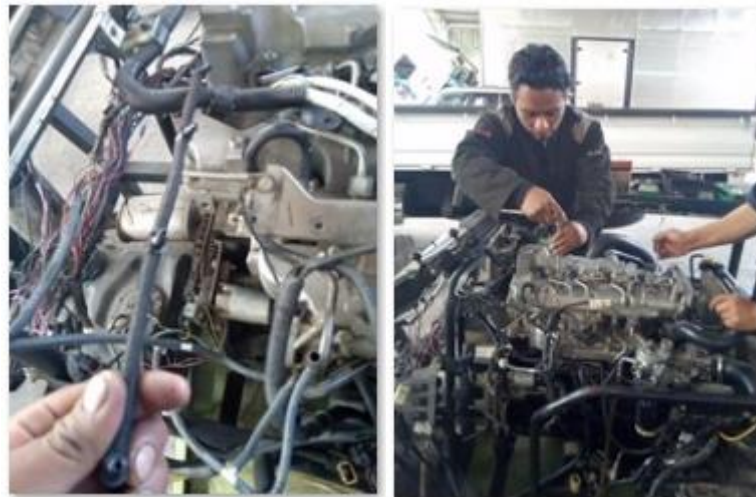
Figura 69 Cañerías de retorno de combustible
