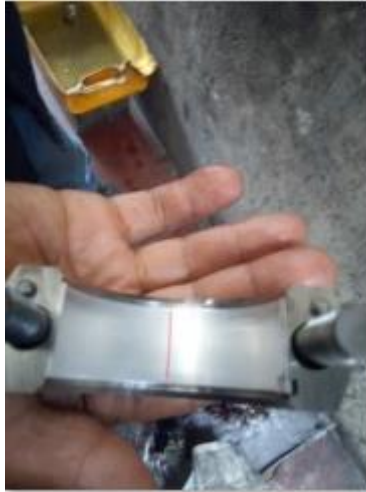
Figura 59 Plastigage sobre el cojinete
