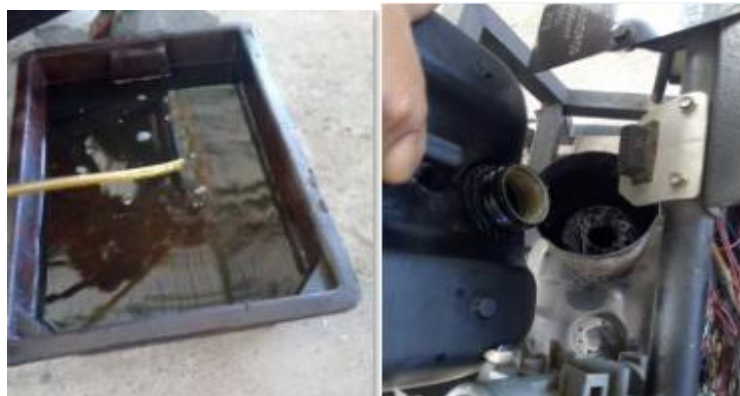
Figura 46 a) Extracción del combustible en mal estado. b) llenado con combustible óptimo.
