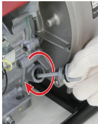
Figura 54 Cerrado de tapa de llenado de Aceite Fuente: Autor
