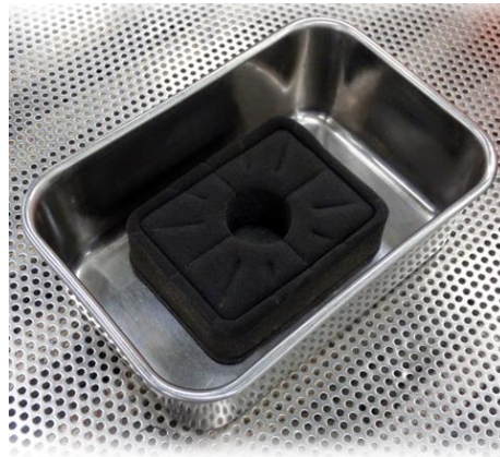
Figura 57 Verificación del Estado del Filtro de Aire
