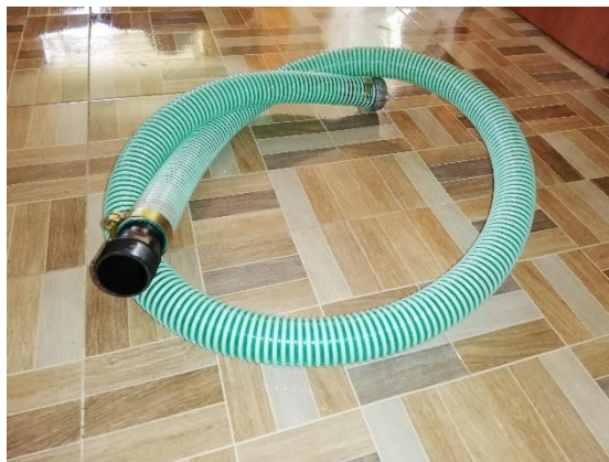
Figura 13 Manguera de Succión
