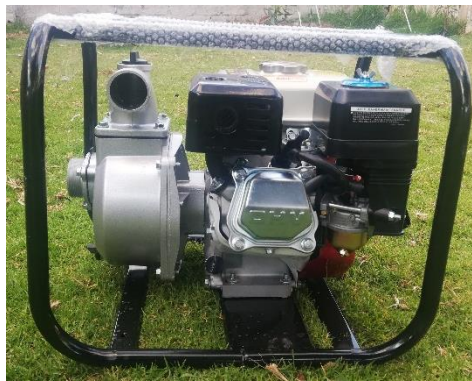
Figura 12 Motobomba de Succión
