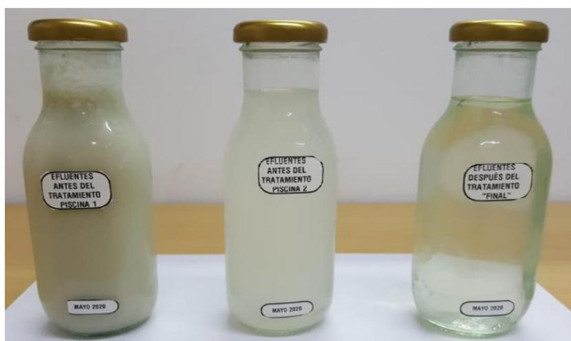
*Figura 3.* Muestras de agua de efluentes lácteos antes y después del tratamiento con el sistema Tohá, empresa INPROLAC S.A.
