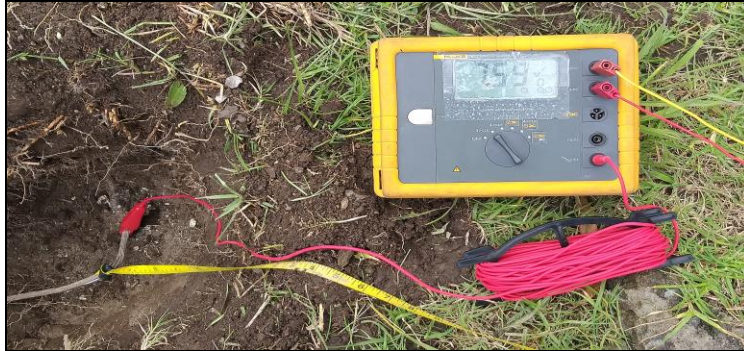
Fig. 21. Conexión del equipo de medición con la tierra de la malla y bobina de tesla. Fuente: (Autor, 2021)
