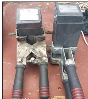
Fig. 51. Tipos de moldes para la soldadura exotérmica. Fuente: (Autor, 2021)
