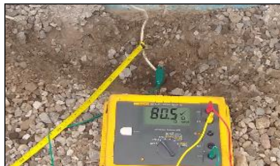
Fig. 26. Conexión del equipo de medición con la tierra del sistema Smart Grid. Fuente: (Autor, 2021)
