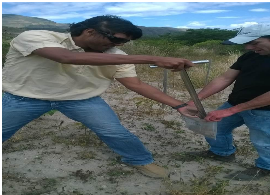
Fotografía 8. Toma de muestras de suelo para análisis de contenido de humedad.
