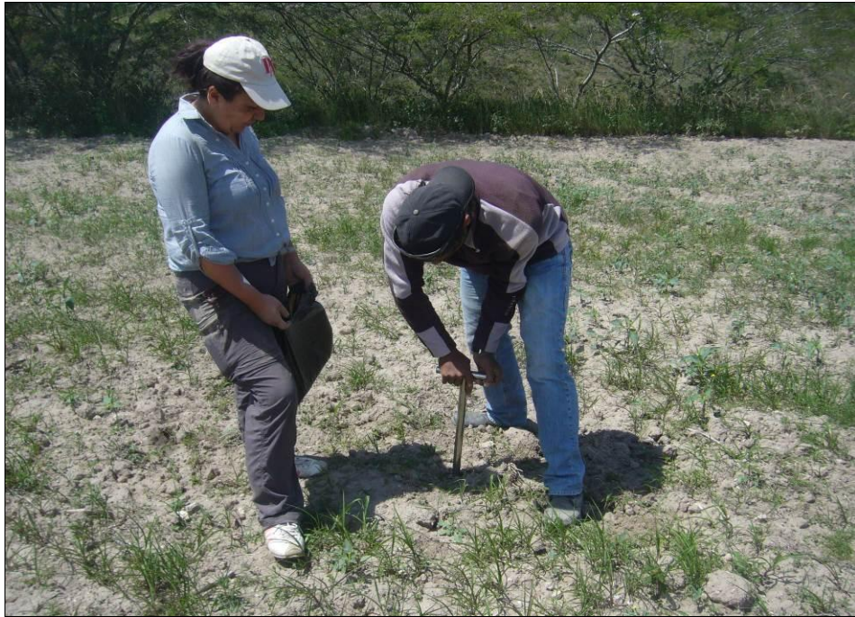
Fotografías 9. Toma de muestras de suelo para análisis de contenido de humedad.
