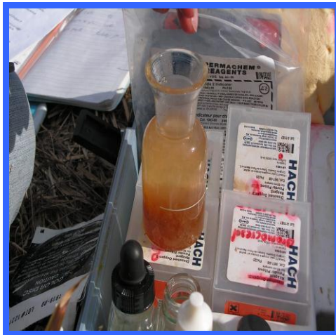
Foto 21. Medición del Oxígeno disuelto Foto 22. Medición de la Turbidez del agua.
