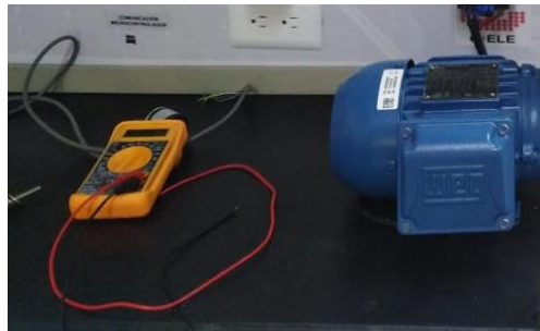
Fig. 48 Montaje del motor trifásico 1/2Hp Fuente: Autor
