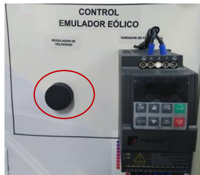
Fig. 6 Perilla de regulación de la velocidad del emulador eólico Fuente: Autor
