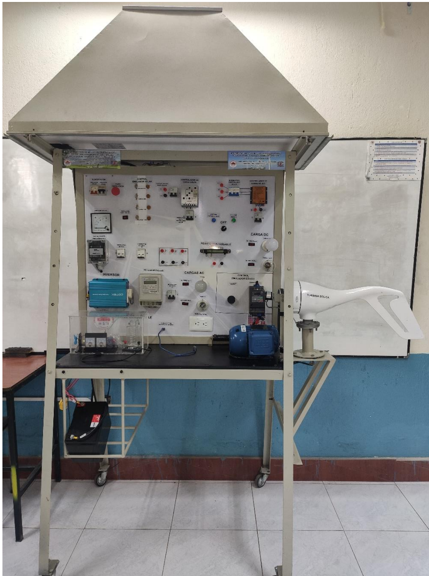
Fig1. Módulo de pruebas del sistema eólico/solar
