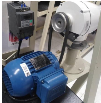
Fig. 50 Colocación de las poleas y correa de transmisión Fuente: Autor
