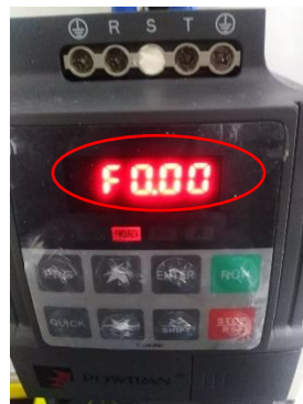
Fig. 4 Display encendido del variador Fuente: Autor
