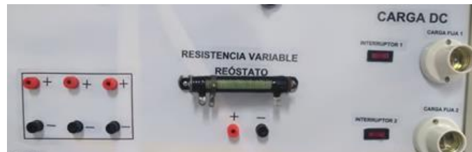
Fig. 46 Montaje e instalación de la resistencia variable y los focos DC Fuente: Autor
