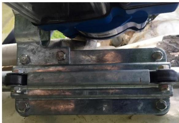
Instalado los motores se determinan los puntos extremos de apertura y cierre de las cortinas, se configuran los finales de carrera que están incorporados en los motores enrolladores los cuales provocan su paro en función de la estructura del invernadero y de la configuración del usuario.
