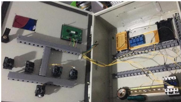
La instalación de la placa Arduino, módulo de relés, se realiza en el lugar de implementación, con el fin de realizar pruebas de funcionamiento y configuraciones de tiempos y límites superiores e inferiores de las cortinas. Finalmente se instala el tablero de control a una altura de 1.5m del piso, y se cubre los cables de potencia de ingreso y salida con material plástico aislante por seguridad del usuario.
