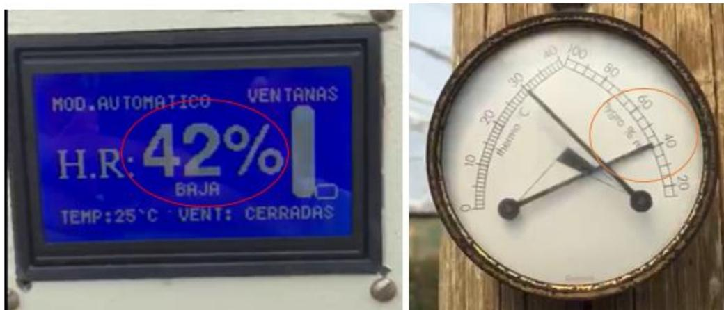
*Nota.* Comparación de datos obtenidos por el sistema mediante el sensor DHT22 y el higrómetro con el que cuenta el invernadero.
