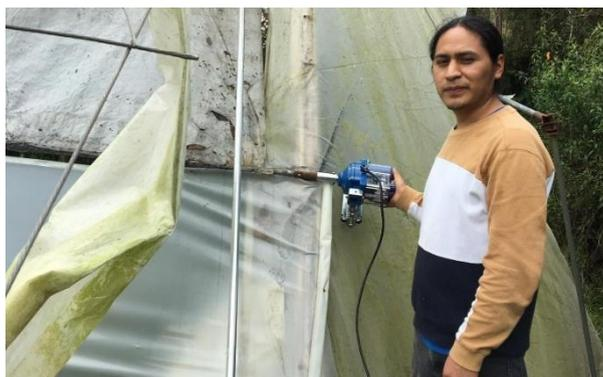
Los motores enrolladores cuentan con un escalador que cumple la función de guiar el motor a lo largo de un tubo inoxidable de  $\frac{3}{4}$  de pulgada empotrado al suelo, como también evitar el giro de la estructura del motor en lugar del eje, lo que provocaría daños en el invernadero y el actuador.
