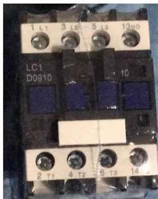
Una vez energizada las bobinas, el contactor alimenta a los motores y provocan su giro en un sentido, para el cambio de giro se utiliza un relé diferente del módulo y se sigue el mismo procedimiento, el relé alimenta la bobina del contactor y este a la vez da paso a la energización del motor en este caso provocando el giro contrario.
