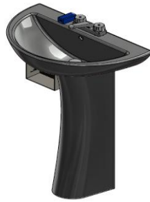
Figura 4.3. Alternativa de solución N°1 (lavamanos), vista isométrica
