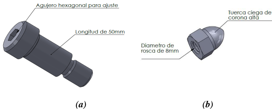
Figura 4.27. Perno pasador agujero hexagonal, (a) vista lateral, (b) Tuerca ciega
