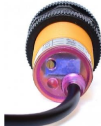
Figura 4.62. Ajuste de distancia por potenciómetro [44]
