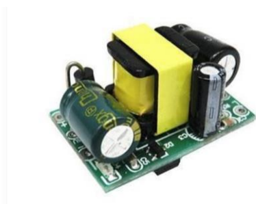
Figura 4.45. Transformador 100V AC a 5V DC [35]
