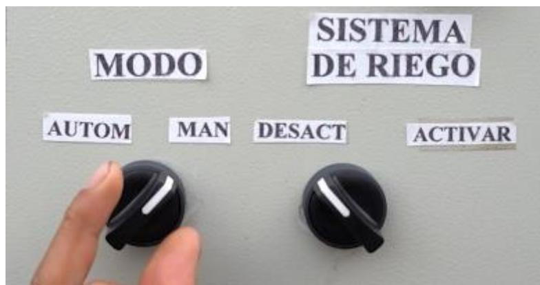
Figura 57. Funcionamiento manual
