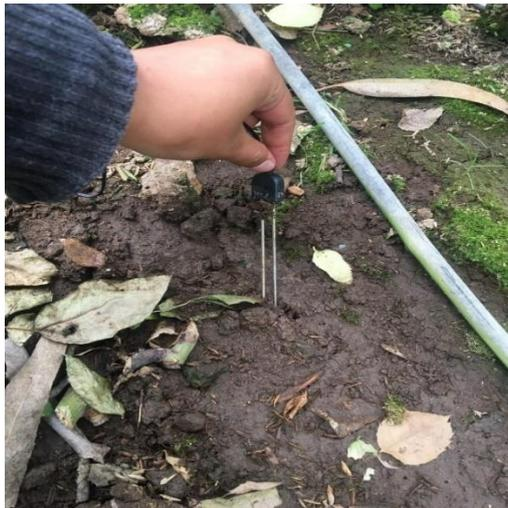
Figura 40. Implementación del sensor de humedad del suelo
