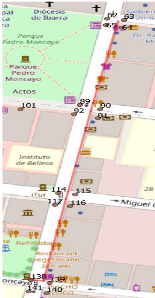
Figura 64. Ruta producida por el algoritmo de Dijkstra en QGIS desde el punto 64 (ubicación usuario) al 138 (Parque del Águila-EMAPA).
