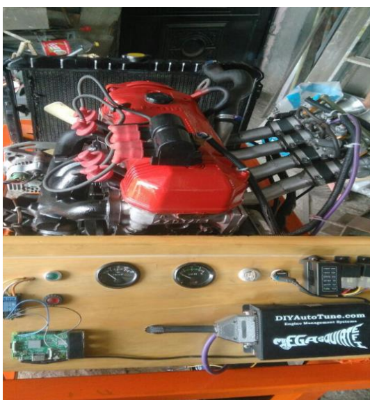
Figura 3.1 Montaje de elementos del sistema de inyección
