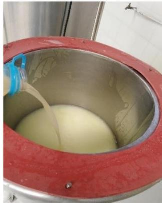
**Imagen 7.** Inoculación de cultivo activado al suero posterior a la pasteurización (24 h antes del proceso)
