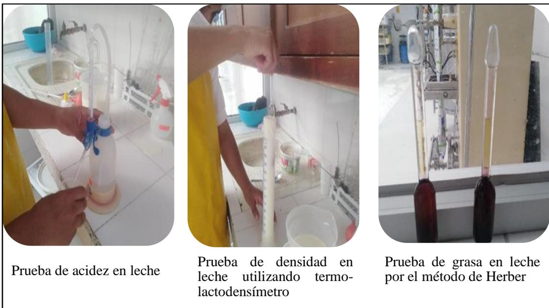
*Imagen 1.* Pruebas de plataforma para la recepción de materia prima
