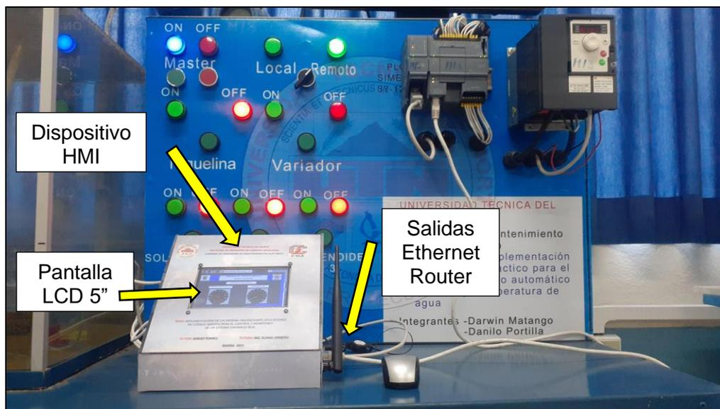
Figura 25. Montaje del Dispositivo HMI
