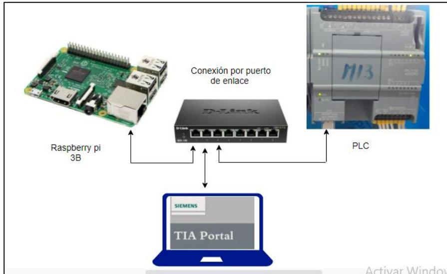
Figura 15. Conexión de PLC, Raspberry pi y Tia portal mediante un Switch Ethernet
