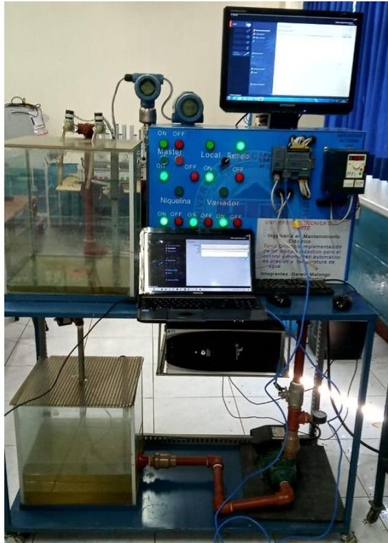
Figura 9. Módulo de control de presión y temperatura de agua, Laboratorio Control
