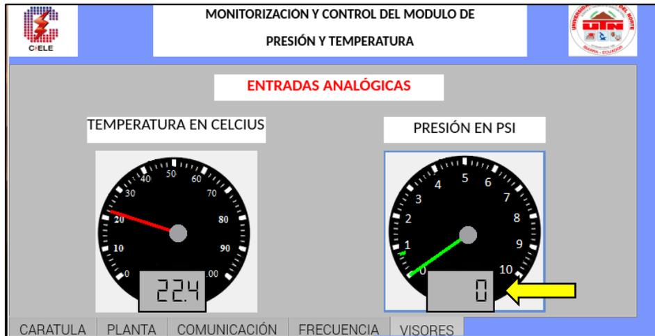
Figura 31. Visualización de presión y temperatura en estado inicial
