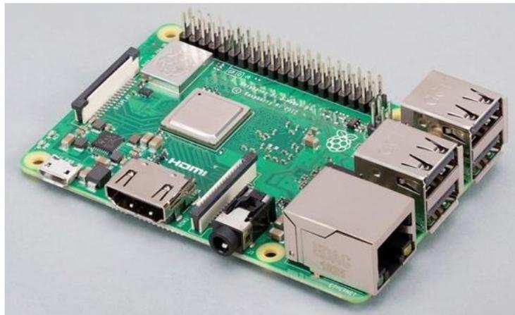
Figura 10. Raspberry pi 3 modelo B plus
