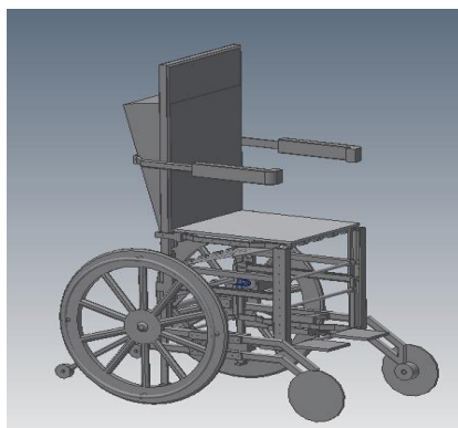
Figura 2 9 Silla de ruedas de bipedestación
