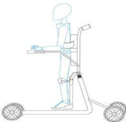
Figura 2.7 Prototipo de bipedestador para pacientes pediátricos
