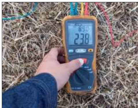
Figura 55: Resistencia de varilla instalada caso estudio 3
