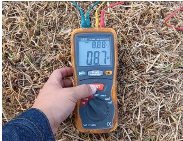
Figura 60: Resistencia de varilla instalada caso estudio 3
