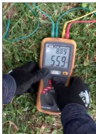
Figura 43: Resistencia de varilla instalada caso estudio 1
