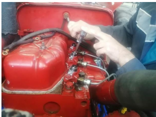
Anexo 3. Simulación de fallas por medio de ajuste de tornillo de los inyectores.
