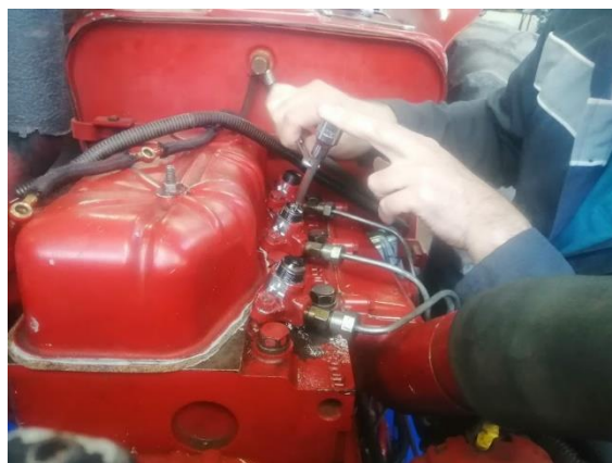
Figura 2.23. Variación de tornillos de reglaje de los inyectores, falla 1.
