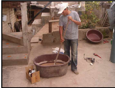
Fotografía N° 3.9. Lavado con ácido clorhídrico
