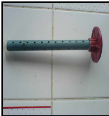
Fotografía N° 3.4. Conducto de drenaje
