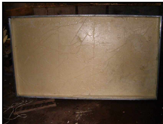
Fotografía N° 3.15. Aislante de poliuretano
