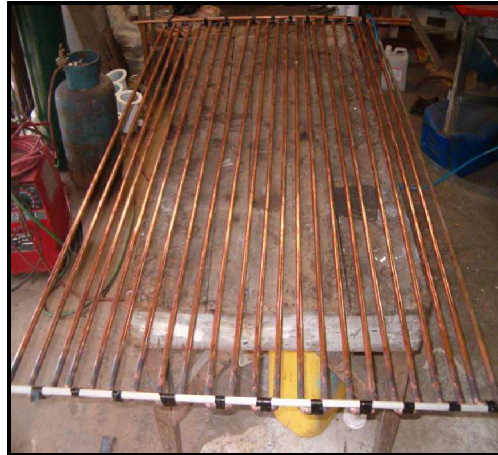
Fotografía N° 3.17. Tubería en serpentín
