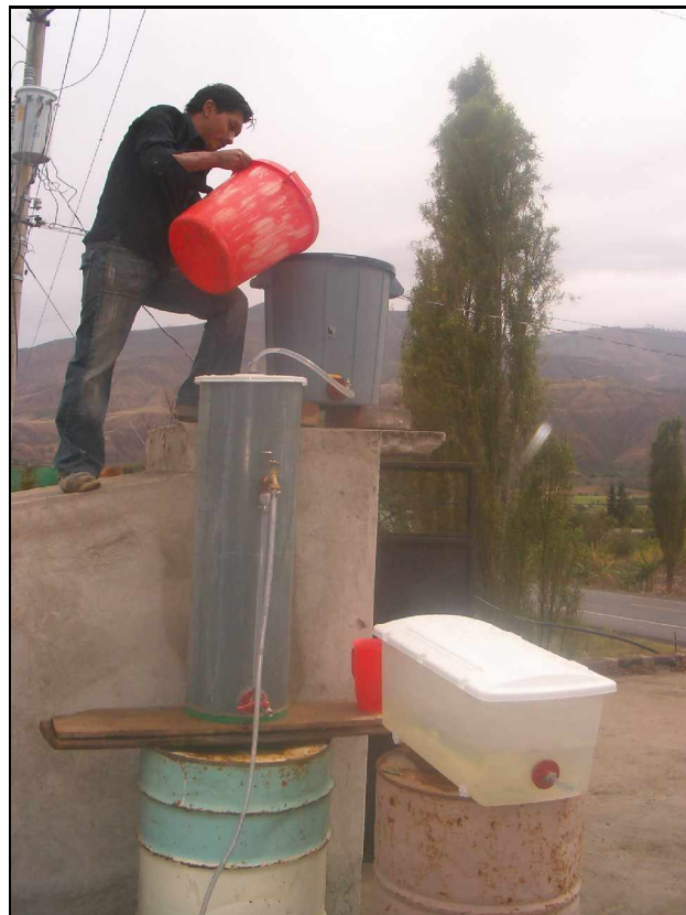
Fotografía N° 6 Llenado de agua cruda para su filtración
