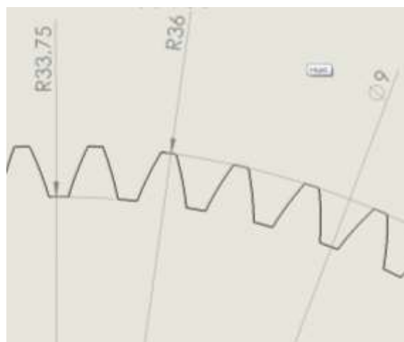
Figura 31. Medidas de radios de engrane recto.
