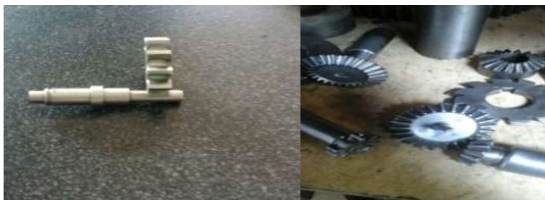
Figura 49. Construcción de eje y engranes.
