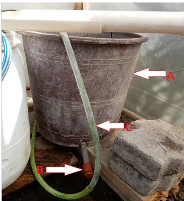
Figura 38. A. Recipiente solución nutritiva; B. Desfogue; C. Manguera de retorno. Fuente: Elaborada por el autor
