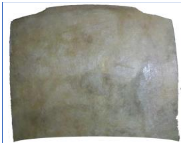
Figura 2.21 Capot elaborado mediante estratificación manual (Pachacama Nasimba, 2015, pág. 13)
