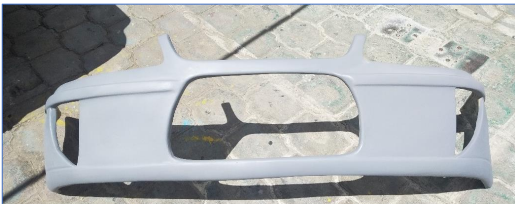
Figura 3.26 Pintura de fondo del parachoques
