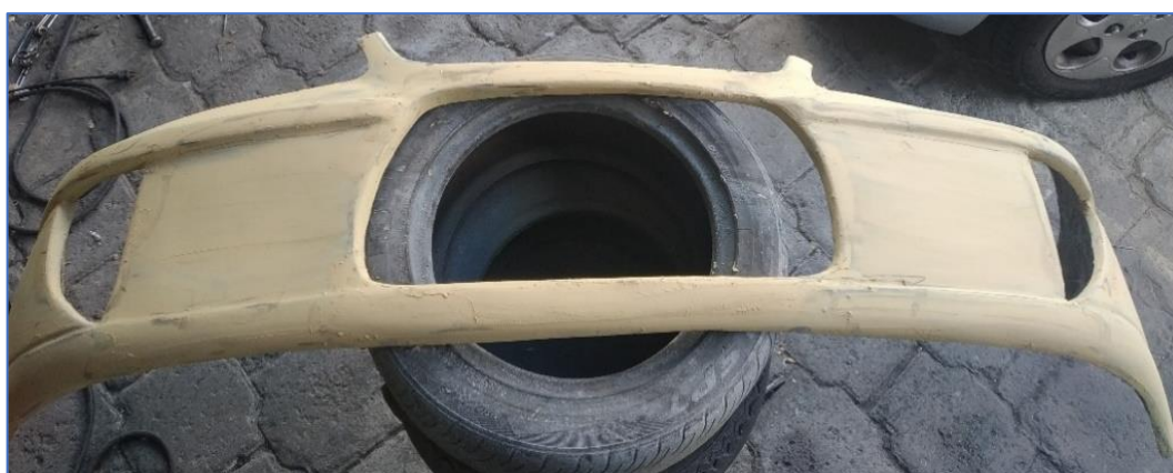
Figura 3.24 Aplicación de masilla
