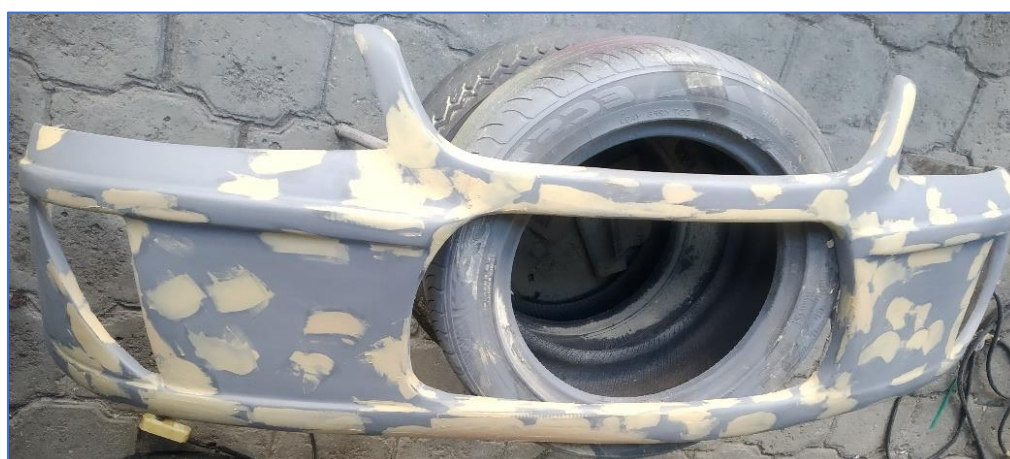
Figura 3.27 Segunda aplicación de masilla
