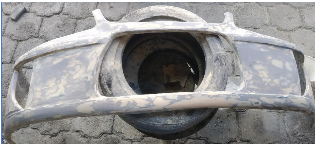
Figura 3.28 Pulido final del parachoques
