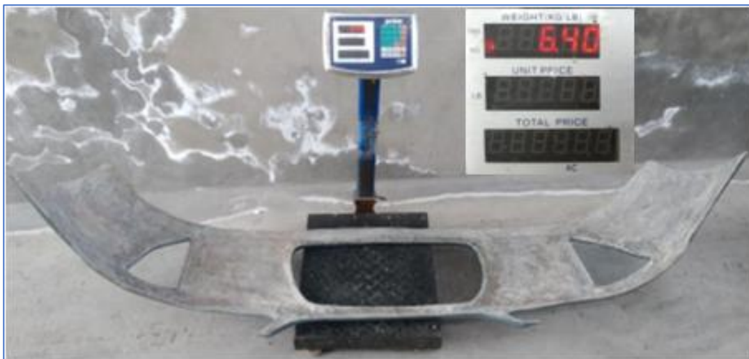
Figura 3.32 Masa del parachoques modificado
