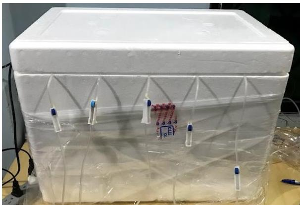
*Nota: Los biorreactores se encuentran sumergidos en el agua mientras que el calentador sumergible lo mantiene a una temperatura de 31° C.*
