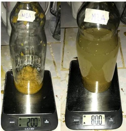
Se procedió a medir el pH de cada una de las muestras completas, esto con el fin de cumplir lo que nos dice (Botero, 1987), que debe estar entre un pH de 6.5 a 7.5 para un óptimo funcionamiento (figura 7). Luego, se insertó los tapones de caucho en los biorreactores, estos tapones tienen introducida una manguera de suero que servirá como conducto para el biogás y una válvula para abrir y cerrar el paso de esta. Una vez preparado todos los biorreactores se introdujeron en la termo espuma.
