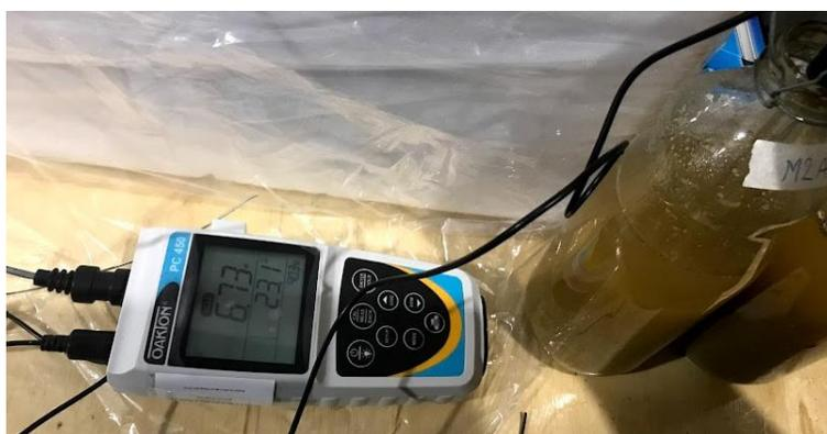
Los biorreactores realizaron la digestión anaerobia en un área hermética como se puede apreciar en la figura 8. Para poder mantenerlos a una misma temperatura sin pérdida por diferencia de temperatura del ambiente, se utilizó un contenedor de termo espuma, en este se introdujo la
