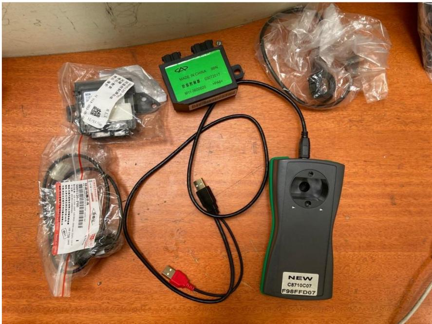
**Figura A IV.** Elementos para la construcción de banco de pruebas de módulos inmovilizadores
