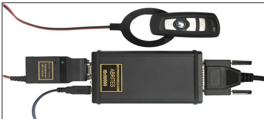
**Figura 1.19** AVDI Programador con Funciones de Diagnostico
