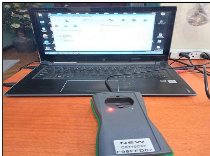
**Figura 3.67** Comunicación equipo Tango Key Programmer a ordenador
