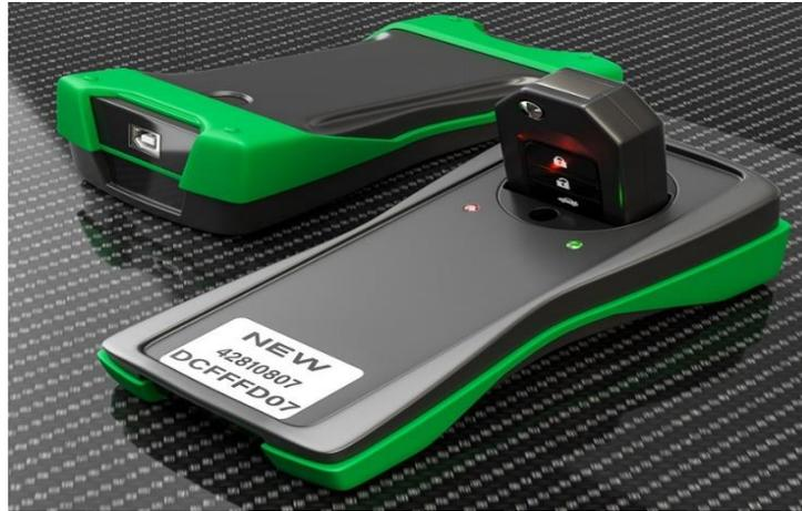
**Figura 1.20** TANGO MAKER Programador de Transponder y Generador de Llaves
