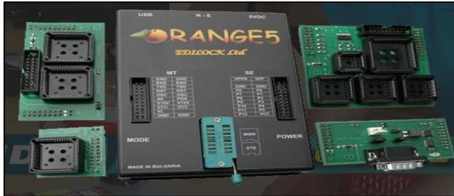
**Figura 1.18** Orange 5 Programador de Memorias EEPROM Y Microcontroladores
