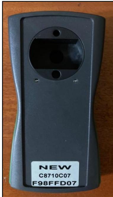
**Figura 2.26** Equipo de programación de transponder Tango Key Programmer
