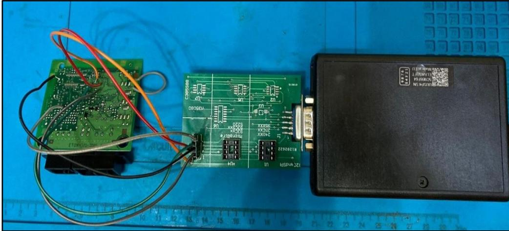
**Figura 3.47** Conexionado con equipo de programación UPA
