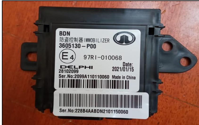
**Figura 3.31** Módulo inmovilizador de la Great Wall - Wingle 5
