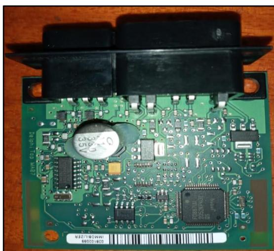
**Figura 3.42** Componentes del módulo inmovilizador
