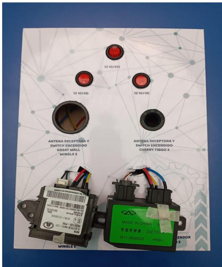
**Figura A VI.** Banco de Pruebas de módulos inmovilizadores
