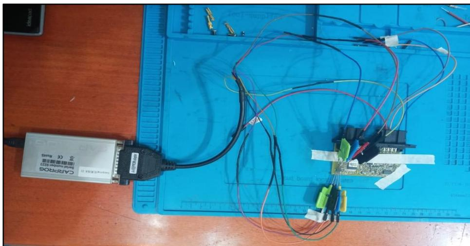
**Figura 3.48** Conexionado de modulo a equipo CARPROG
