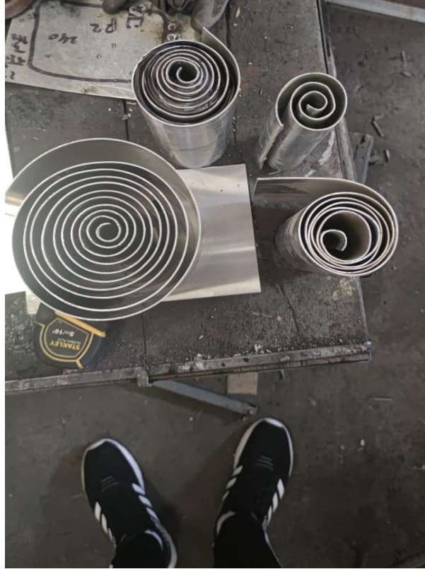
Figura 0.3 Intentos de atenuadores realizados y atenuador terminado.
