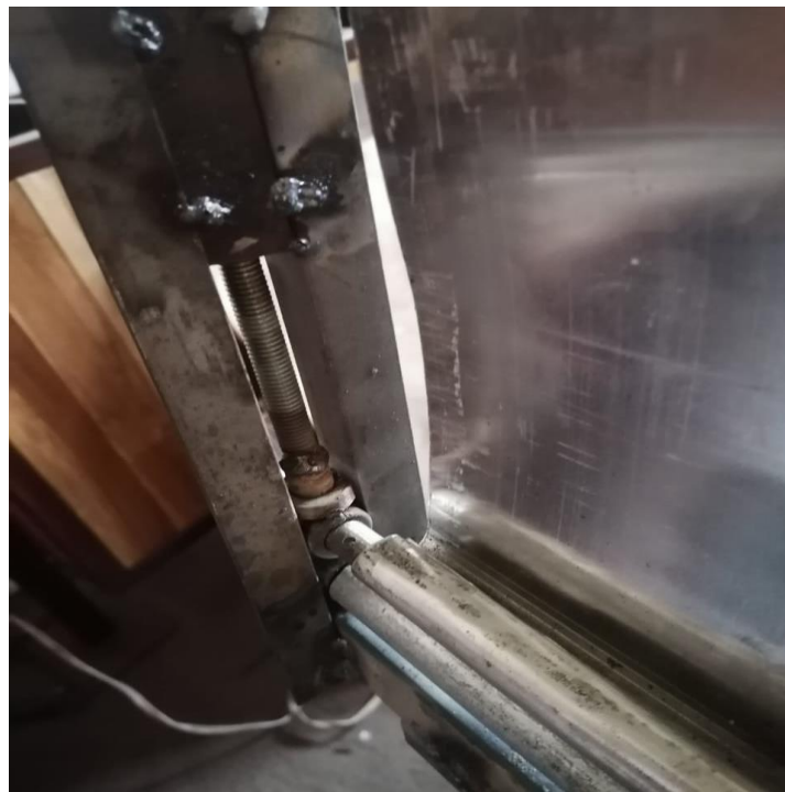
Figura 0.2 Deformación de la plancha de aluminio para dar el molde de espiral.
