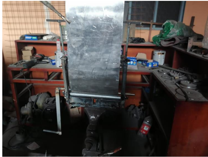
Figura 0.1 Colocación de plancha de aluminio de 1.5 mm.
