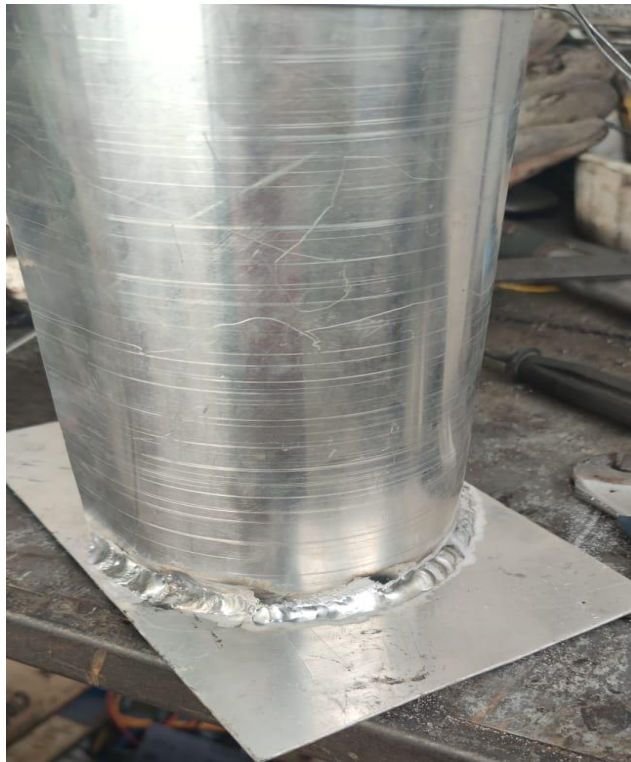
Figura 0.8 Atenuador terminado con su proceso de soldadura.
