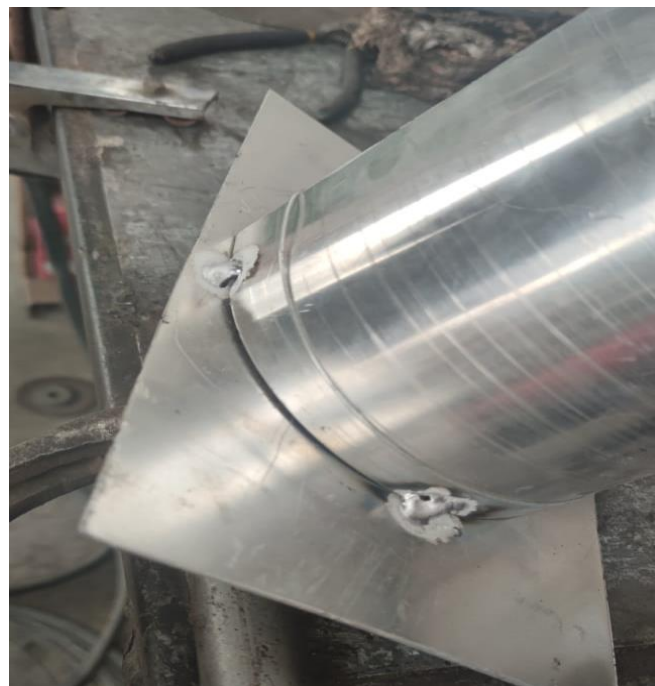
Figura 0.6 Primer unión de soldadura.
