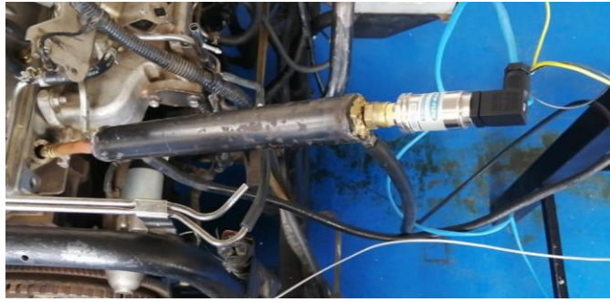
Figura 2. 28 Sensor de presión en funcionamiento
