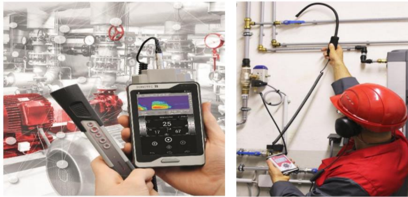
Figura 1. 2 Análisis de ultrasonido (Asensio, 2019, pág. 1)
