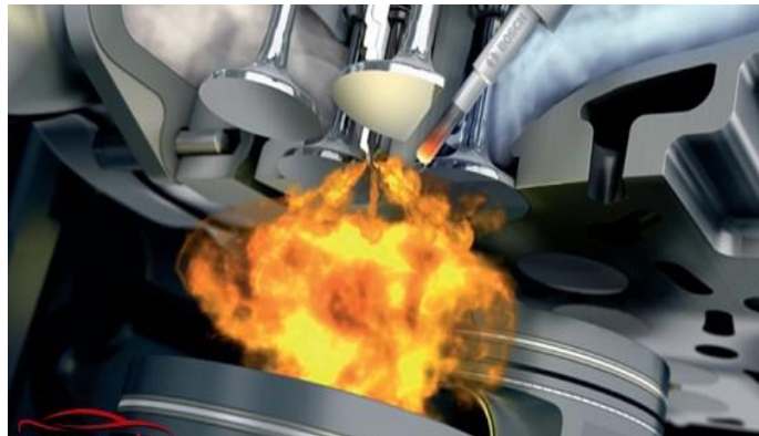
Figura 1. 4 Proceso de combustión del motor diésel (Ferrer, 2021, pág. 1)
