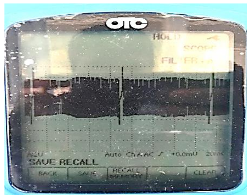
Figura 3. 1 Señal del sensor CKP
