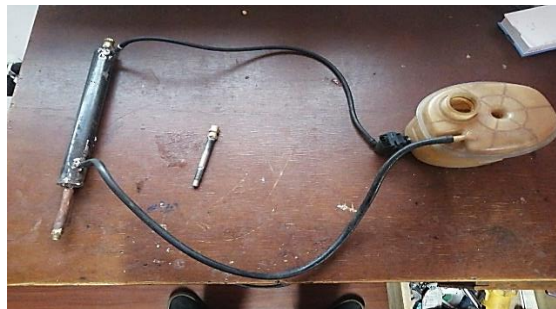
Figura 2. 27 Sistema de refrigeración
