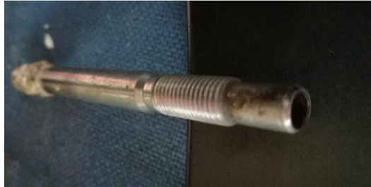
Figura 2. 26 Bujía de Precalentamiento perforada
