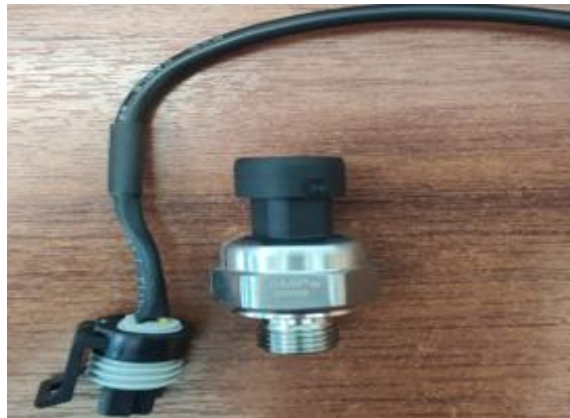
Figura 2. 4 Sensor de presión y modo de conexión
