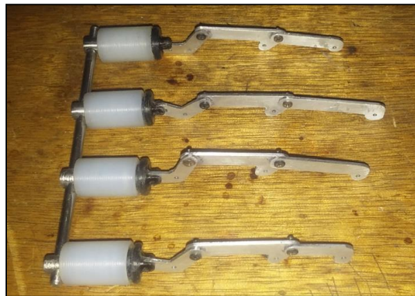
Fig. 2-28 Mecanismos internos de los dedos
