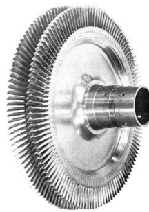
Figura 1.23 Turbina de dos escalones del turbohélice Bristol Tesen
