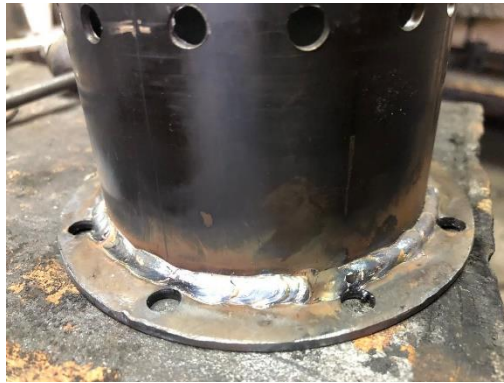
Figura 2.35 Soldadura del anillo en el difusor
