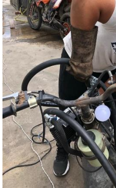
Figura 2.41 Instalación de las mangueras
