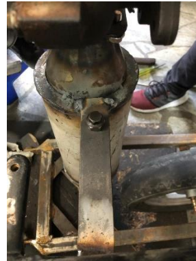
Figura 2.39 Base de la cámara de combustión
