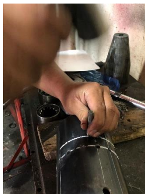
Figura 2.30 Señalamiento de puntos
