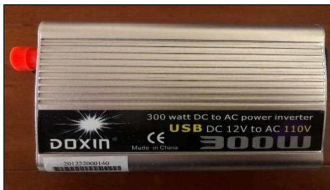
Figura 2.19 Inversor de corriente
