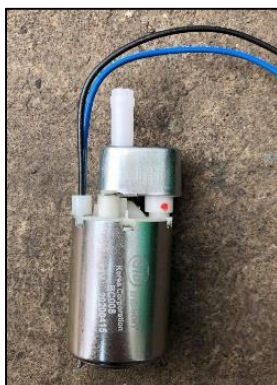
Figura 2.14 Bomba de agua
