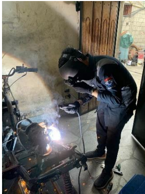
Figura 2.38 Soldadura de bases
