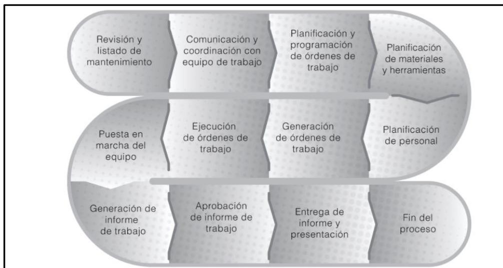
Figura 2.1 Diagrama de proceso de mantenimiento correctivo (Gonzalez Ajuech & Gonzalez Ajuech, 2017, p.44)
