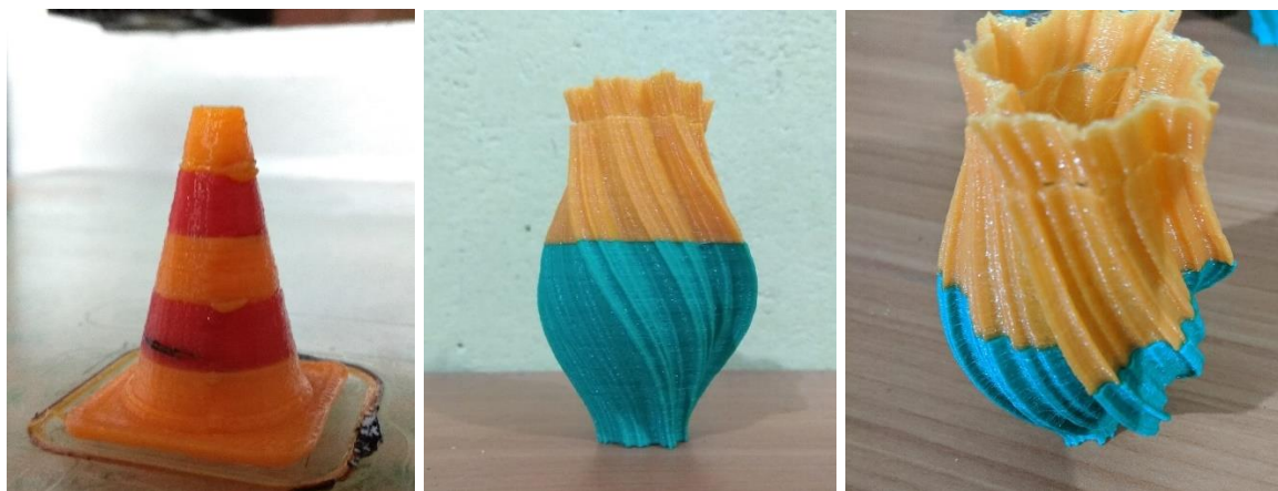
Figura 38 Impresión de 2 colores ajustados. a) Cono bicolor, b) vista frontal de un florero, c) vista isométrica del florero.
