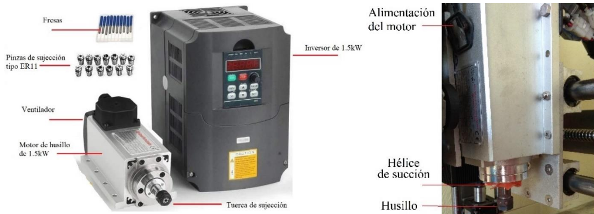
Figura 10 Módulo de fresado. a) Fresado e inversor [39], b) fresadora implementada en la impresora
