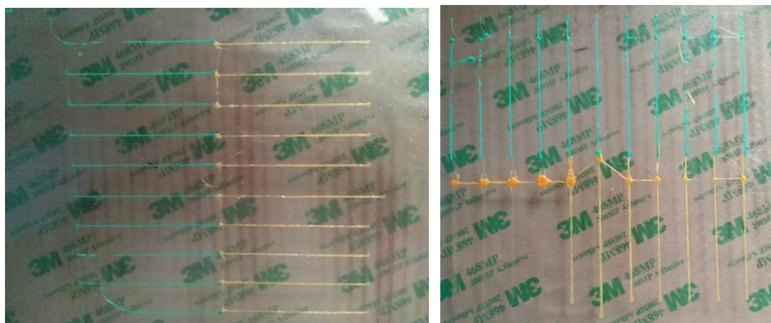
Figura 37 Calibración de los extrusores 1-2 [30]. a) eje X, b) eje Y
