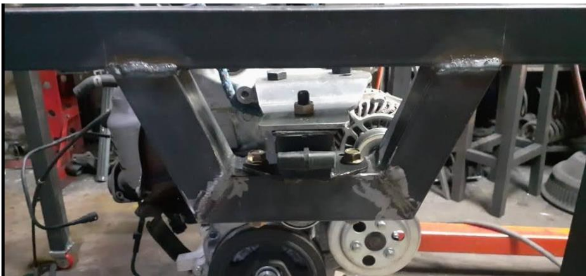
Figura AII. 2 Puntos de apoyo del motor
