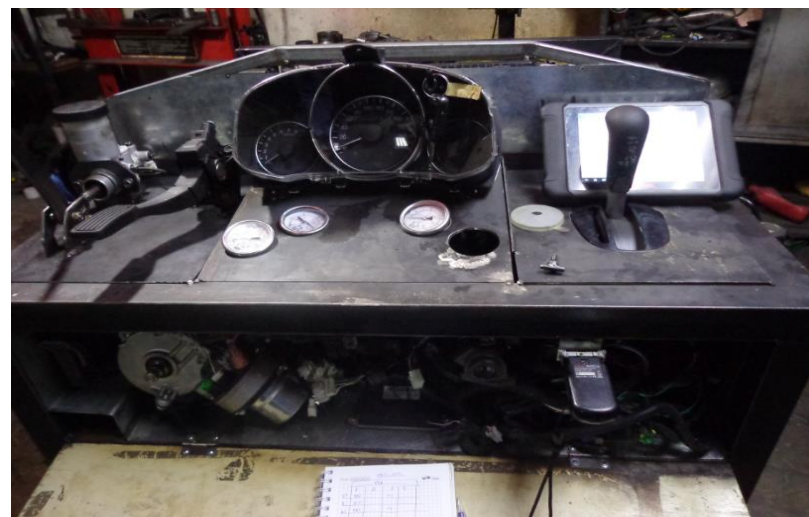
Figura AII. 5 Sistema eléctrico y manómetros de presión
