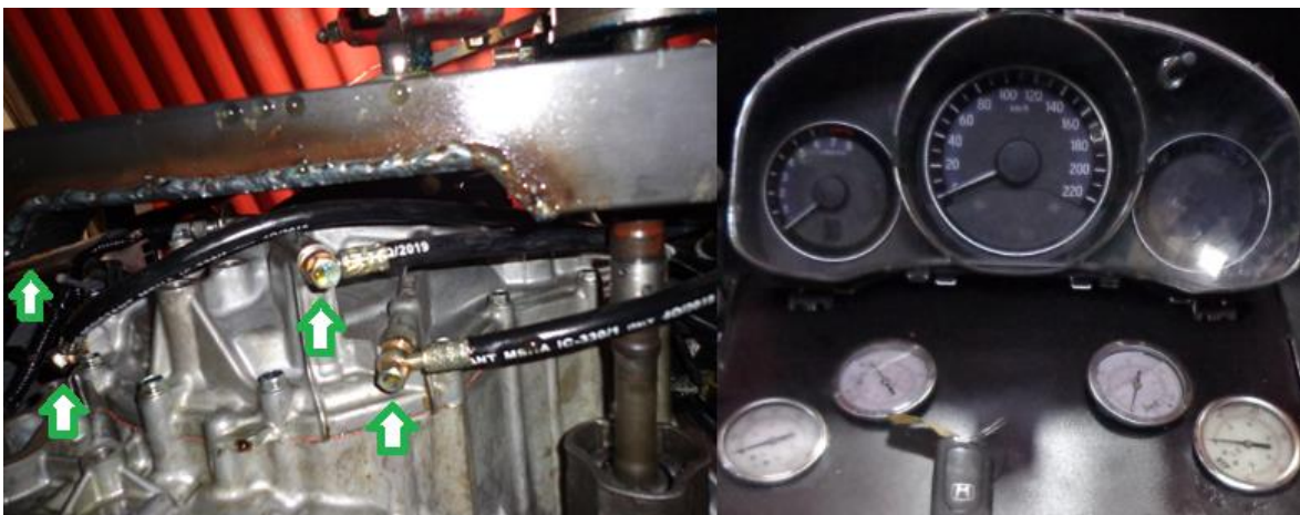
Figura 2. 10 Manómetros y cañerías de presión
