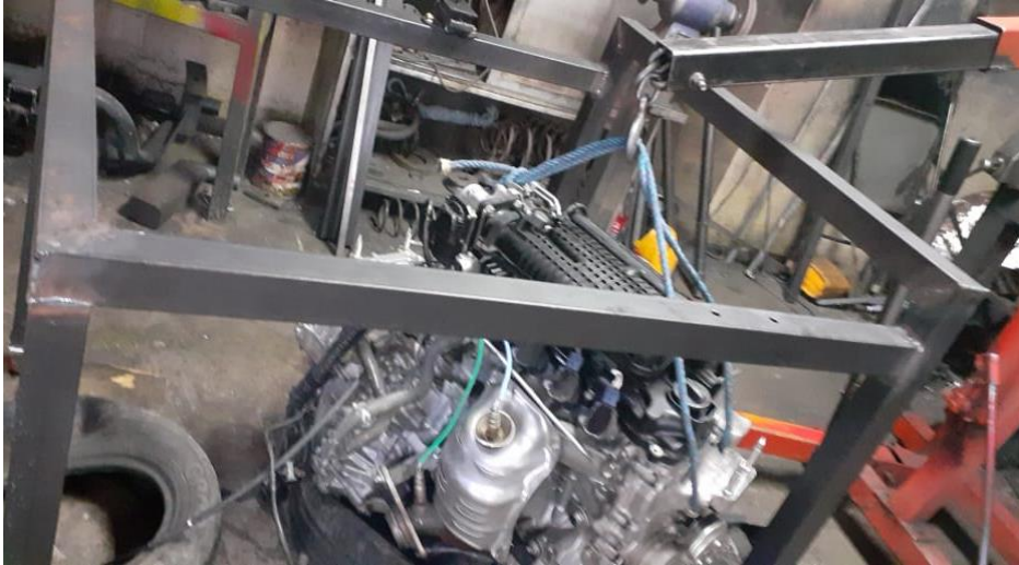
Figura 2. 9 Montaje de motor sobre estructura metálica
