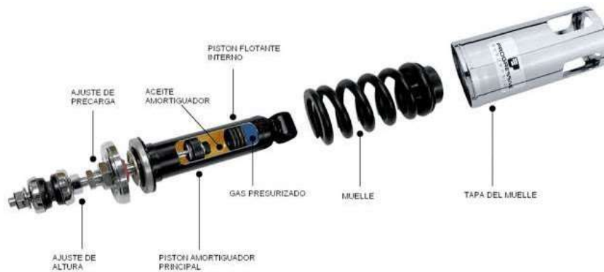
Figura 4. Amortiguador y sus partes
