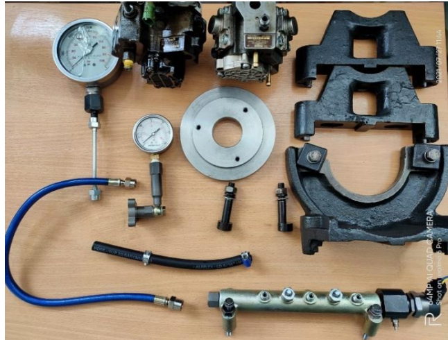
Figura 2.9 Componentes del banco de pruebas de bombas de alta presión
