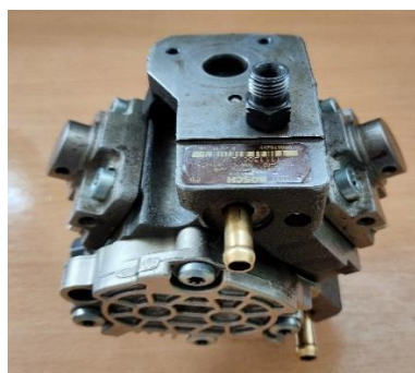
Figura 2.2 Bomba de alta presión
