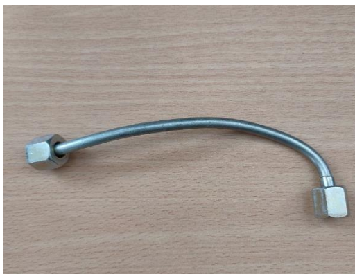
Figura 2.8 Cañerías de alta presión
