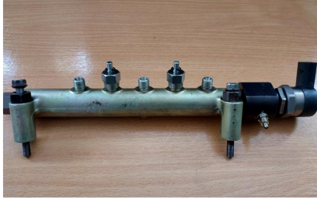
Figura 2.7 Acumulador de alta presión
