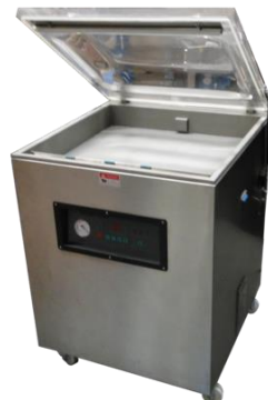
Figura 22 Empacadora al vacío
