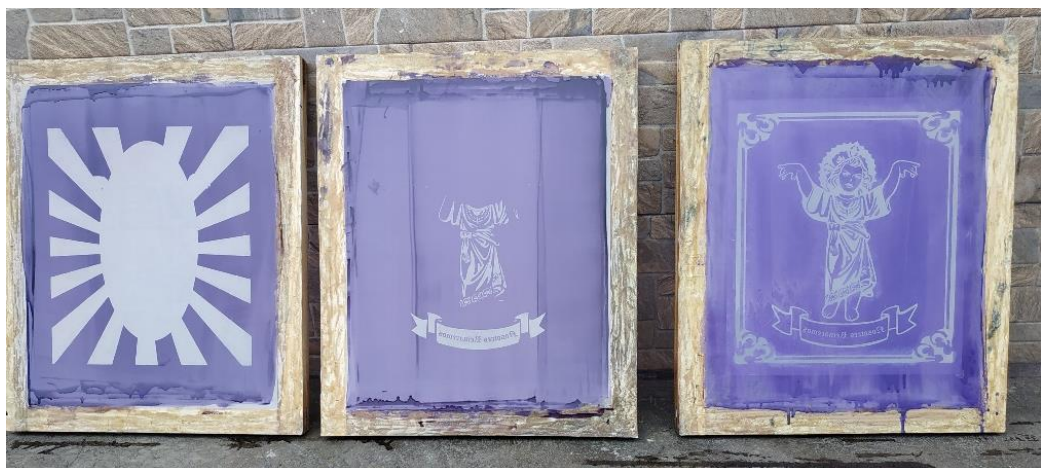
Figura 32 Retiro de emulsión. Fuente: Autor del proyecto.
