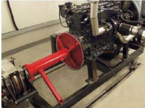
Figura 3. Imagen representativa de un motor de combustión interna acoplado a un banco de ensayo de motores.
