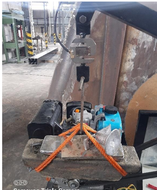
Figura 21. Calibración de celda de carga con 30 kg de peso
