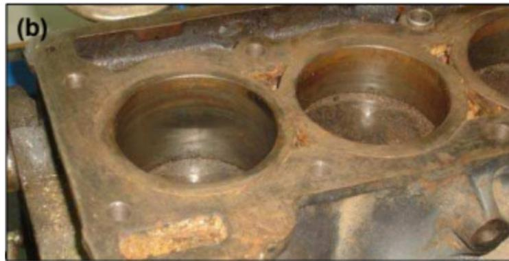
**Figura 1.17** Bloque de cilindros integral
