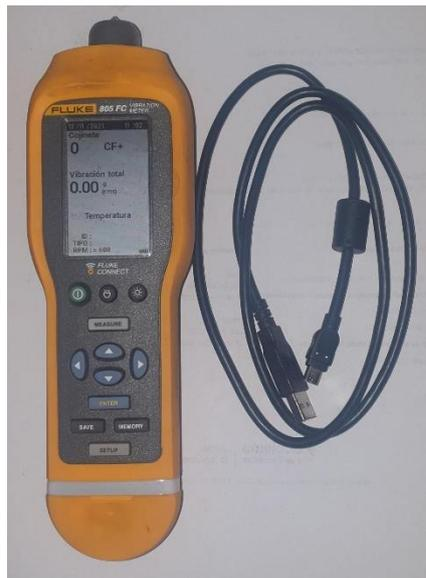
**Figura 2.1** Analizador de vibraciones.
