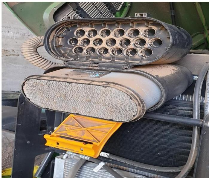
**Figura 2.9** Filtro de aire saturado de impurezas.
