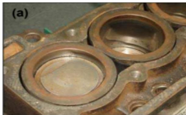
**Figura 1.18** Bloque de cilindros con camisa
