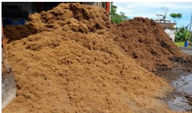
Figura 2.3. Fibra, subproducto de la extracción de aceite crudo de palma, Energy Palma S.A. 2021
