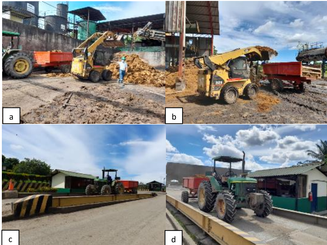
Figura 4.2. Recolección de raquis (a), fibra (b) y peso de materiales (c) y (d) a utilizar en el proceso de descomposición de compostaje.
