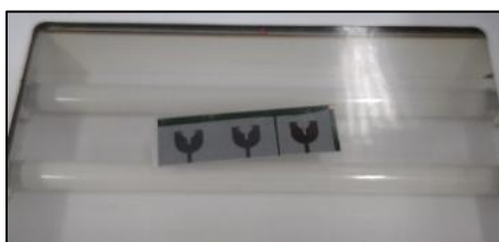
Figura 88 Proceso de Insolación de la plantilla y con la placa FR-4
