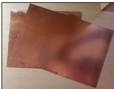
Figura 84 Sustrato FR-4 con altura de 1.6 mm
