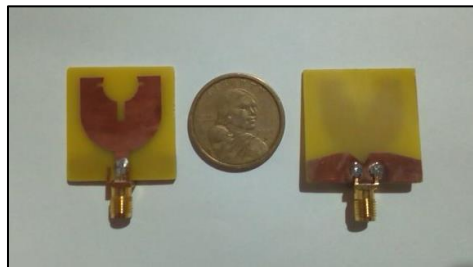
Figura 91 Antena UWB Final
