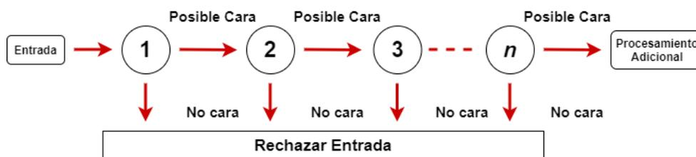
**Figura 21.** Un diagrama de flujo de clasificadores en cascada. (Fuente de imagen)
