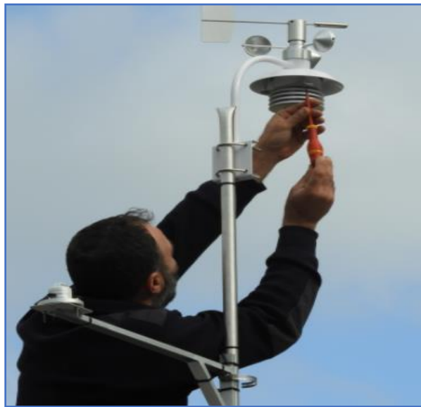
Figura 3. Calibración al sensor de viento Fuente: (Meteocultura, 2021)
