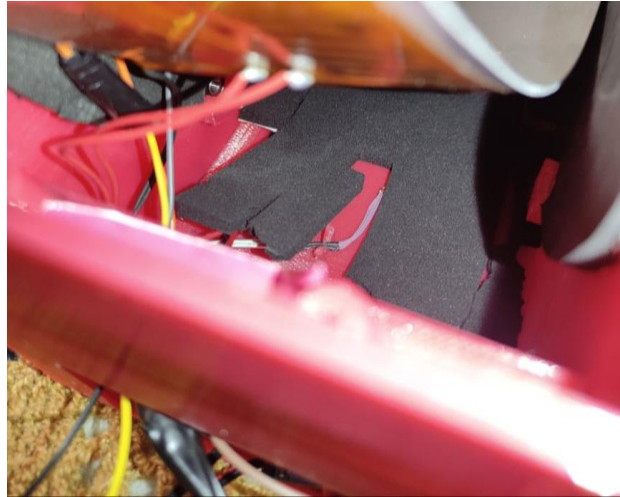
Fig. 3-3 Localización Termistor de la base del Secador
