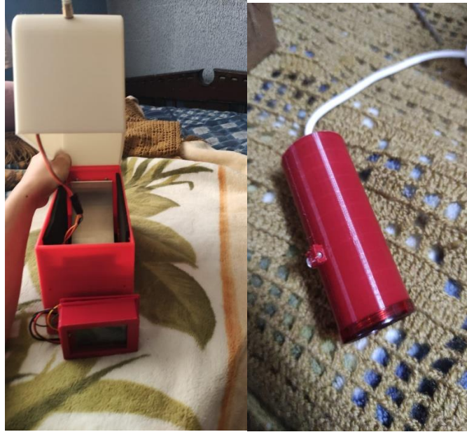
Fig. 3-1 Dispositivo de Secado construido y bomba de vacío
