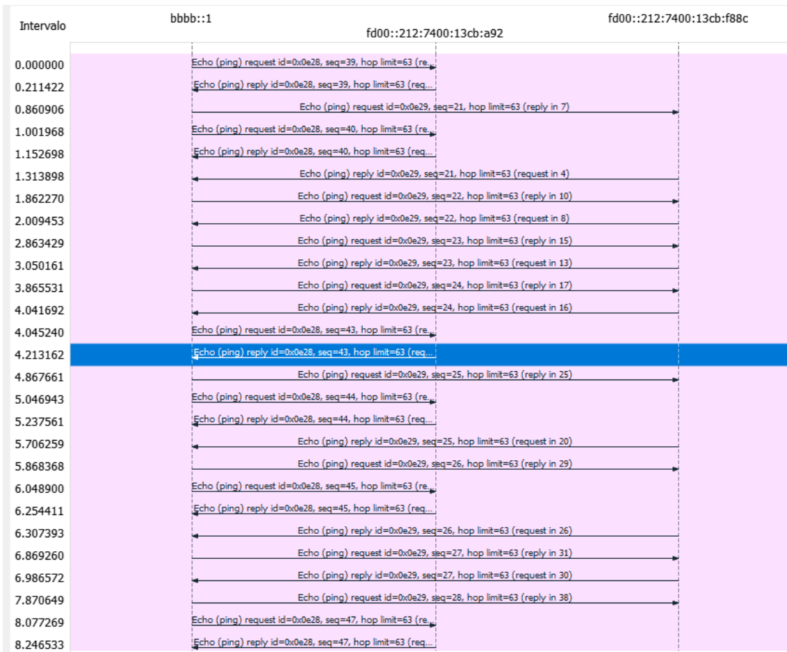
Figura 49. Diagrama de secuencia del comando ping entre el nodo y servidor
