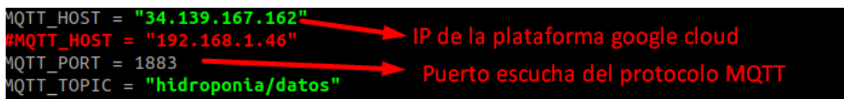
Figura 45. Parámetros para iniciar una comunicación por medio del protocolo MQTT
