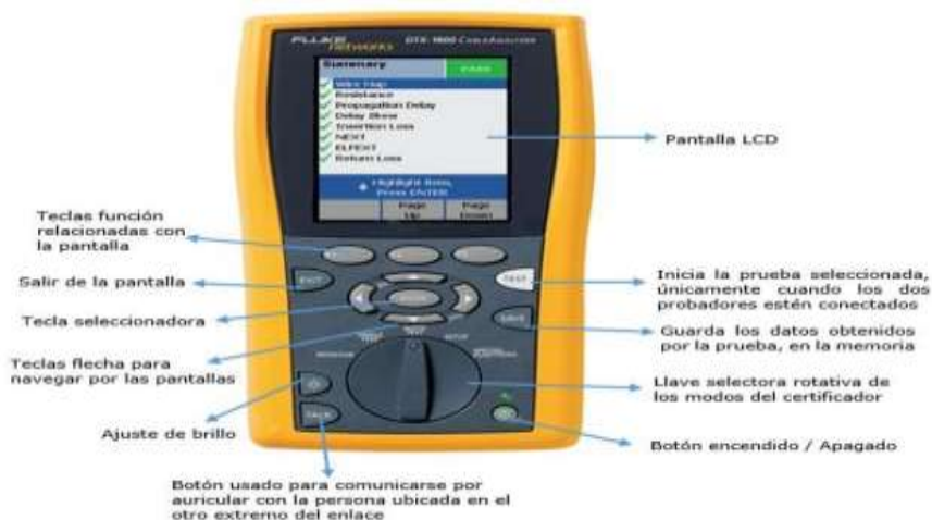
Figura 7. Características Principales del Fluke DTX-1800
