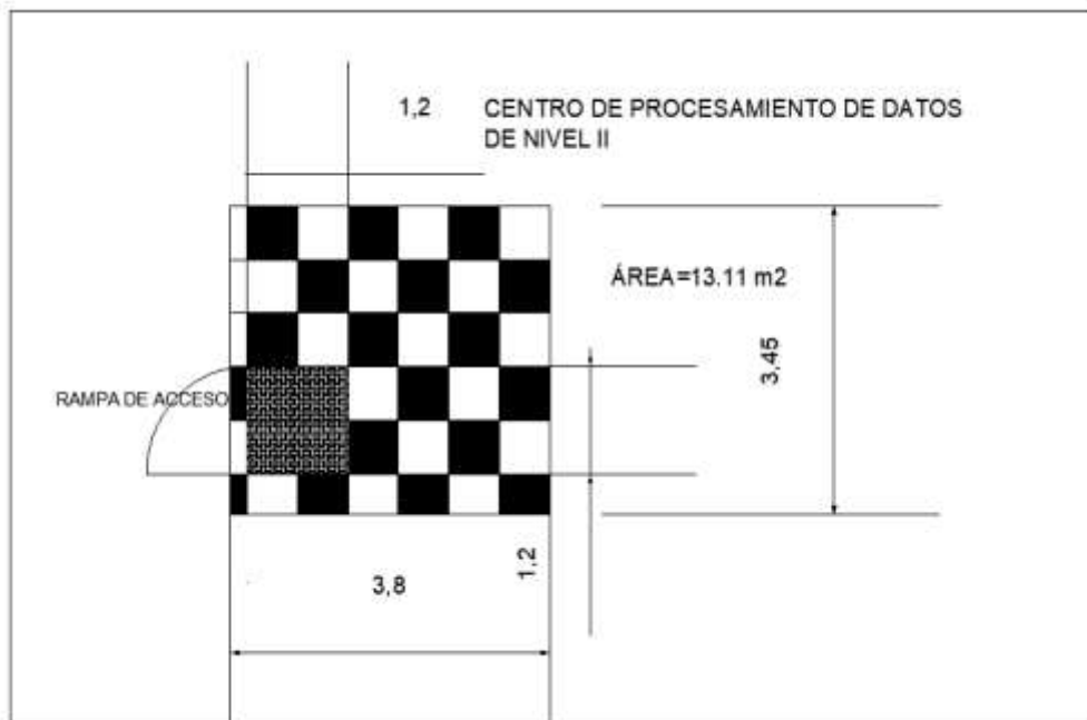
Figura 38. Rampa de Acceso del Centro de Procesamiento de Datos de Nivel II
