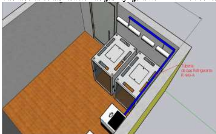
Figura 6. Ubicación de tubería de distribución de gas refrigerante R 449-A en conexión con el Evaporador
