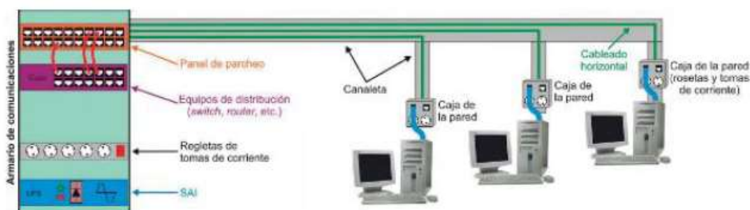
Figura 6. Sistema de Cableado Estructurado, Cableado Horizontal
