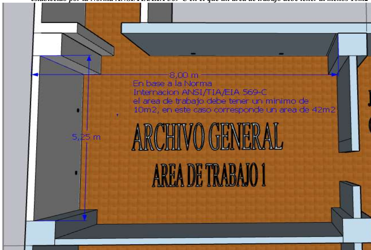
Figura 75. Área de Trabajo 1 de la Segunda Planta del GADMT con un área de 42 m 2 cumpliendo con lo establecido por la Norma ANSI/TIA/EIA 569-C en el que un área de trabajo debe tener al menos 10m 2
