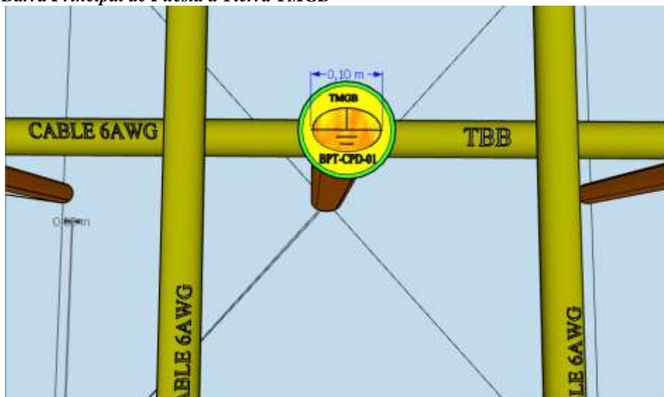
Figura 43. Barra Principal de Puesta a Tierra TMGB
