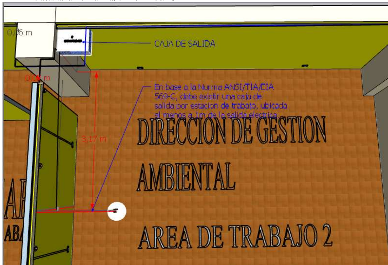
Figura 73. Caja salida en el Área de Trabajo 2 ubicada a una distancia 3.17m de salida de corriente como lo detalla la Norma ANSI/TIA/EIA 569-C
