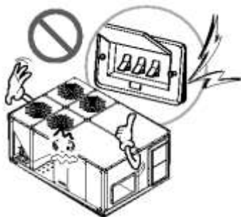
Figura 2. No utilice interruptor automático ya que puede provocar incendios
