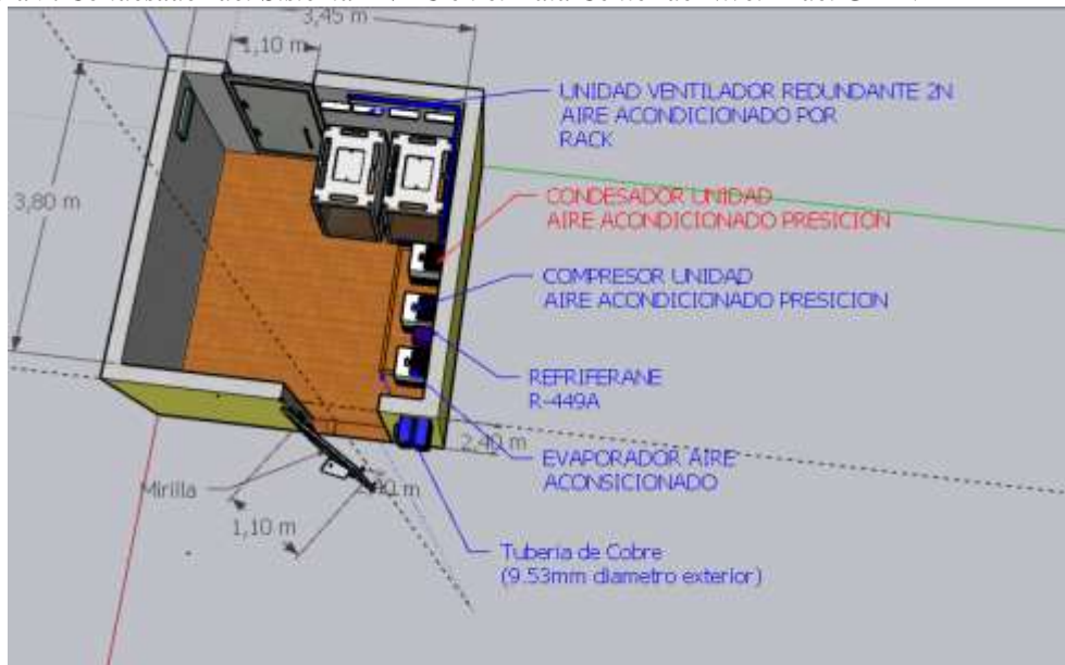
Figura 9. Condensador del Sistema HVAC en el Data Center de Nivel II del GADMT
