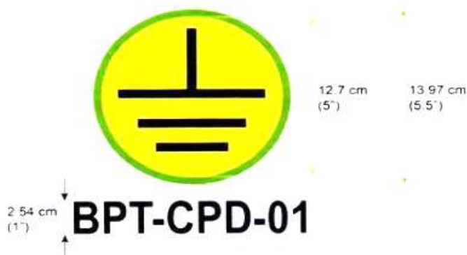
Figura 14. Identificación del Barra de Puesta a Tierra
