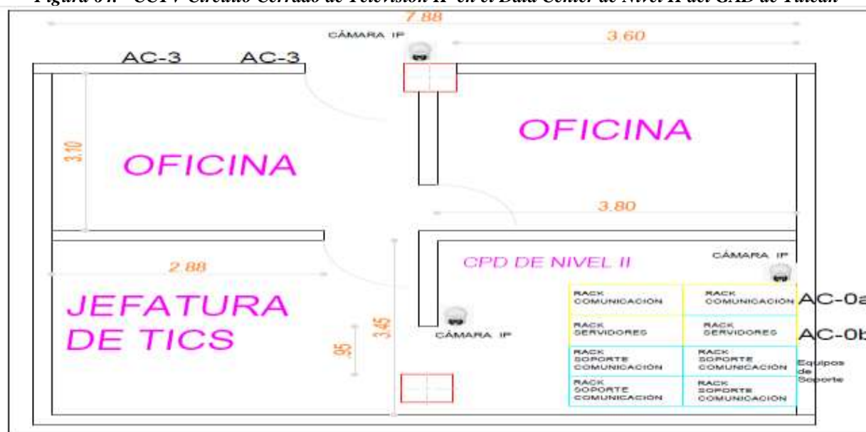
Figura 64. CCTV Circuito Cerrado de Televisión IP en el Data Center de Nivel II del GAD de Tulcán
