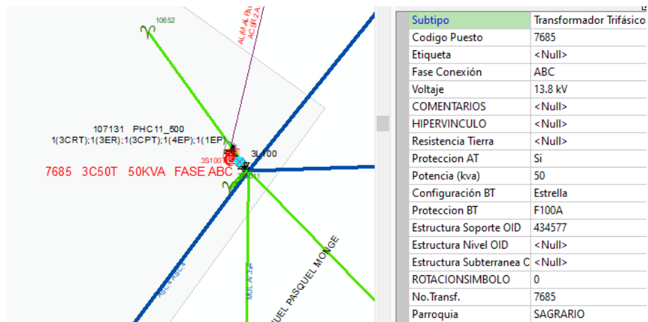
Fig. 16 Características del transformador 7685, tomadas de la base de datos de ArcGIS.
